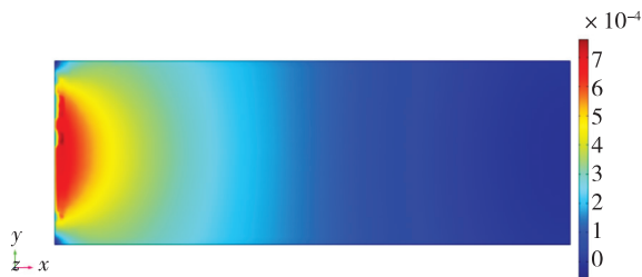
图 1 悬臂梁弯曲模式下的极化情况
