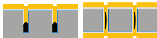
(a) 单面盲孔电镀缺陷
