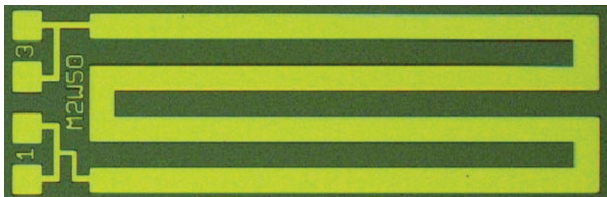
图 4 M2W50(50 \mu\text{m} 条宽)Cu-RDL 检测图形
