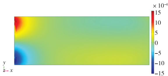
图 2 悬臂梁扭转模式下的极化情况
