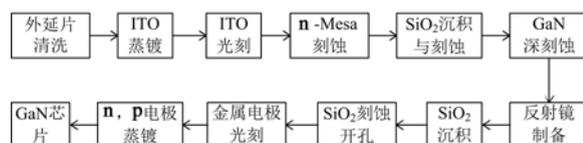
图1 微尺寸LED芯片制备流程
